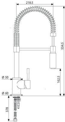
Diamètre de perçage : 35 mm
