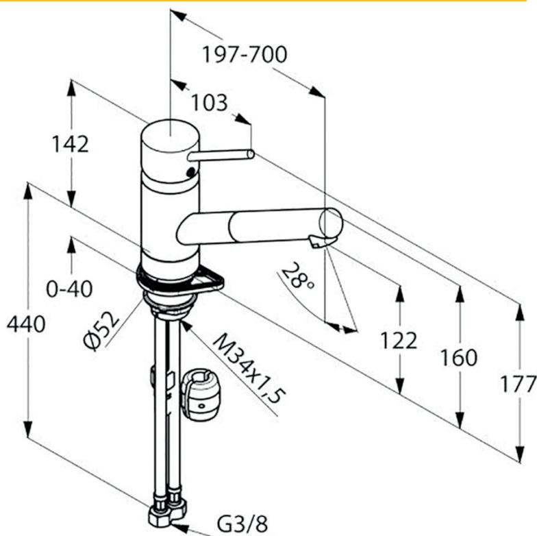
Diamètre de perçage : 35 mm
