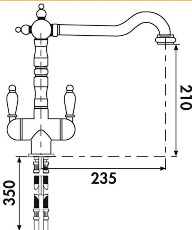
Diamètre de perçage : 35 mm
