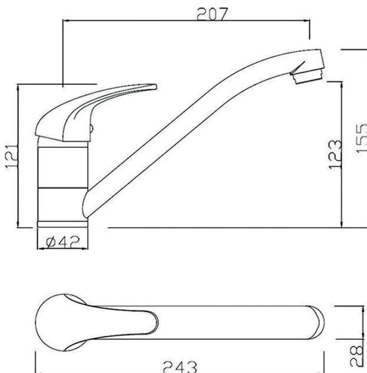
Diamètre de perçage : 35 mm
