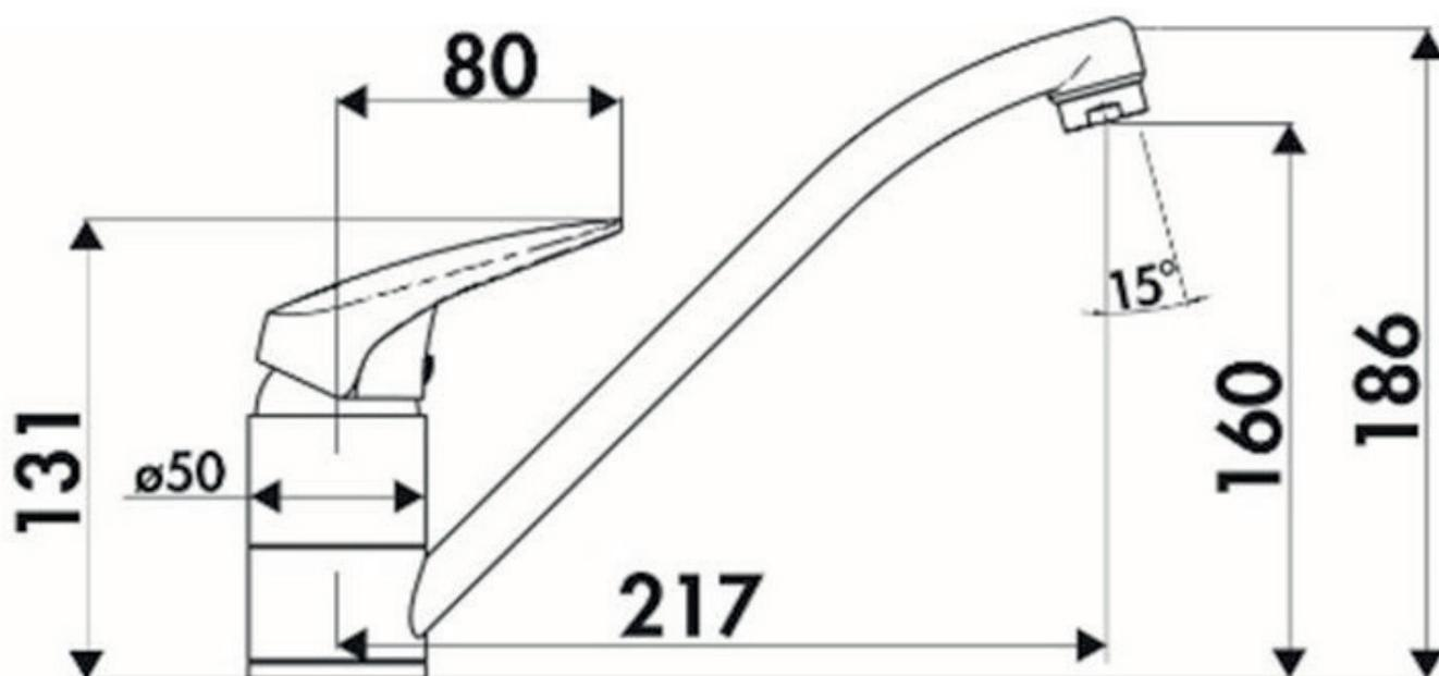
Diamètre de perçage : 35 mm
