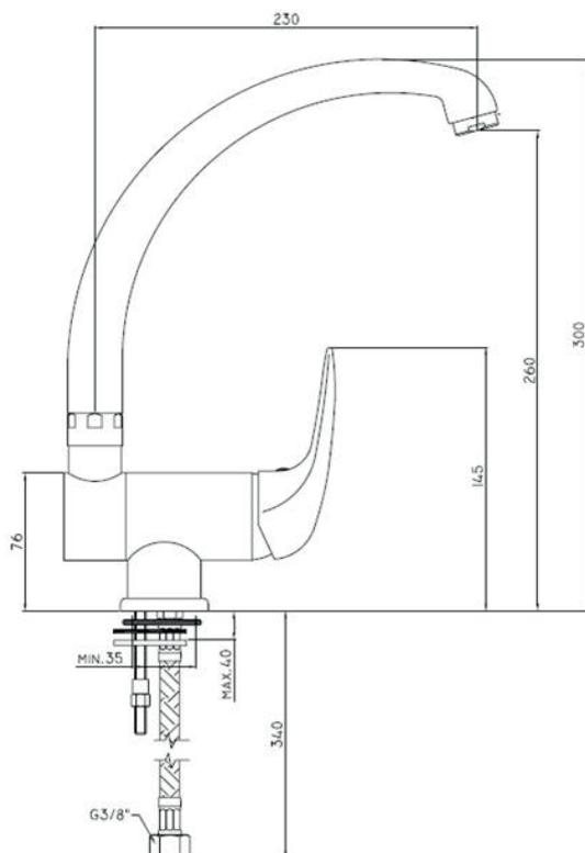
Diamètre de perçage : 35 mm
