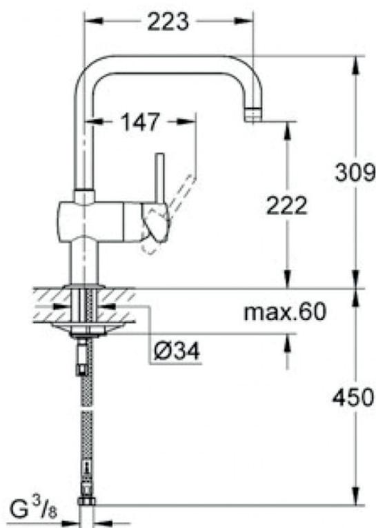
Diamètre de perçage : 35 mm
