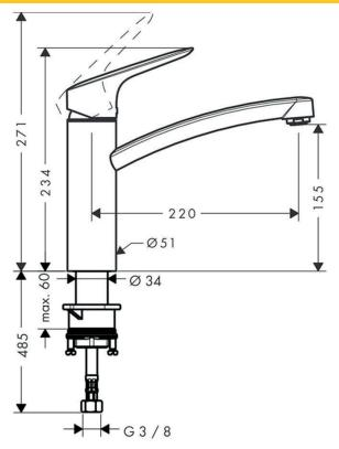
Diamètre de perçage: 35 mm
