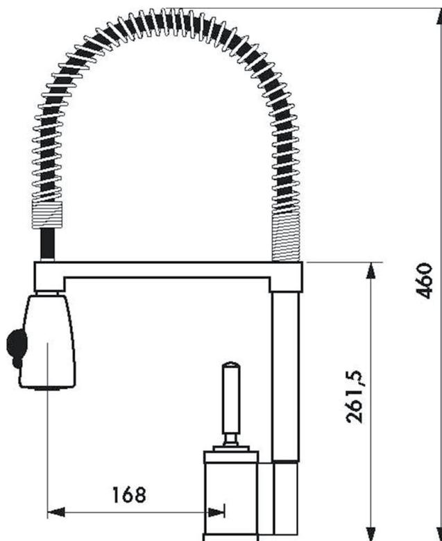
Diamètre de perçage : 35 mm
