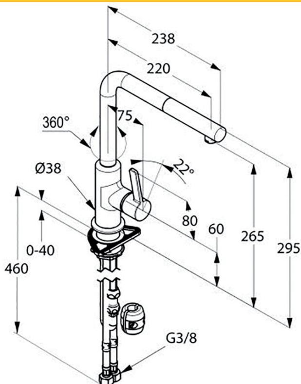
Diamètre de perçage : 35 mm
