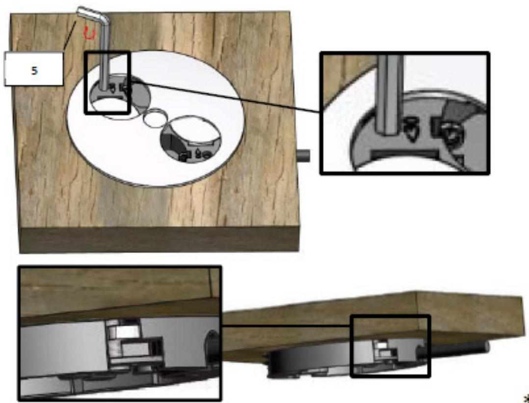
La partie courte de la clé hexagonale en haut. serrez seulement jusqu'au point de pression.
