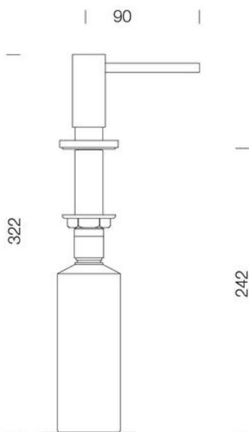
Diamètre de perçage : 35 mm
