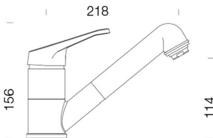
Diamètre de perçage : 35 mm
