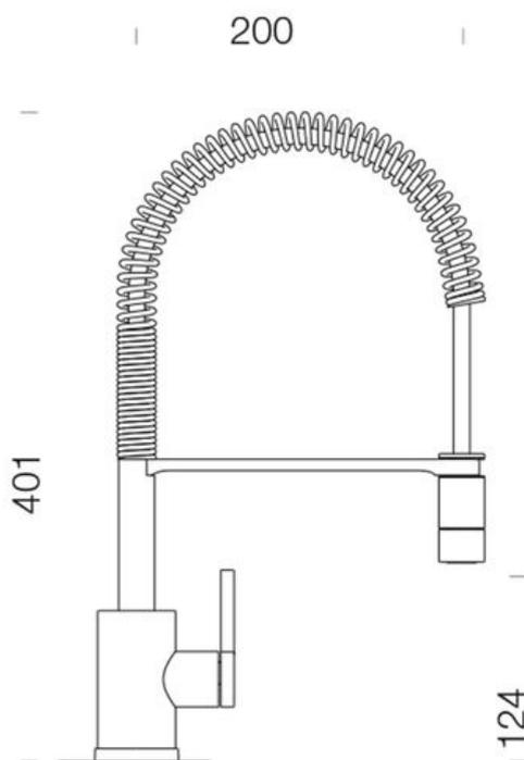
Diamètre de perçage : 35 mm
