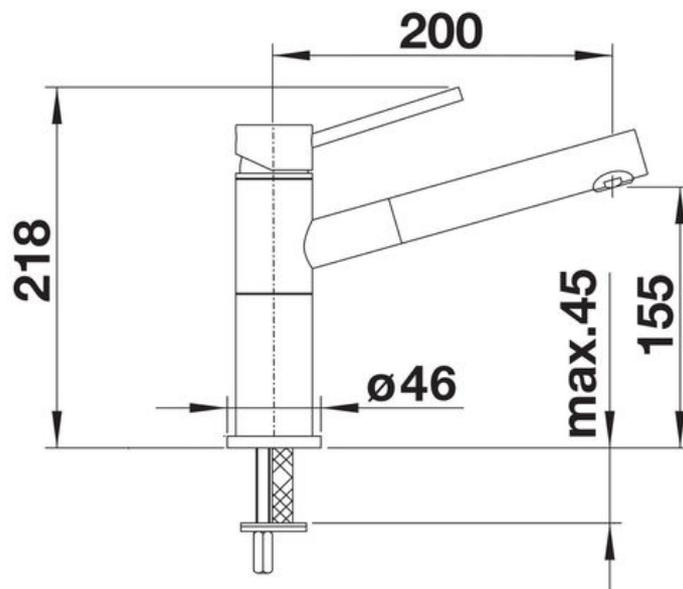
Diamètre de perçage : 35 mm
