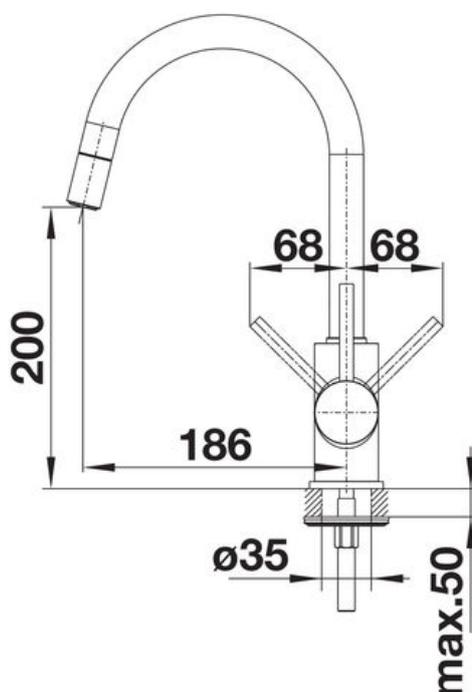
Diamètre de perçage : 35 mm
