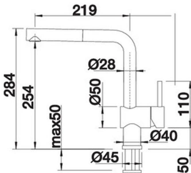
Diamètre de perçage : 35 mm
