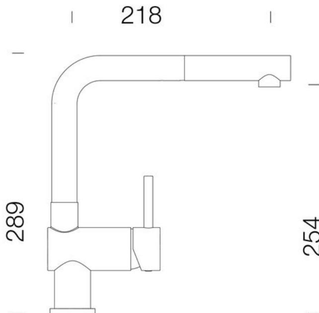
Diamètre de perçage : 35 mm
