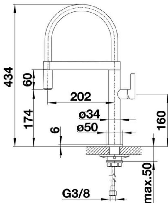
Diamètre de perçage : 35 mm
