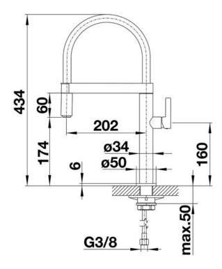
Diamètre de perçage : 35 mm
