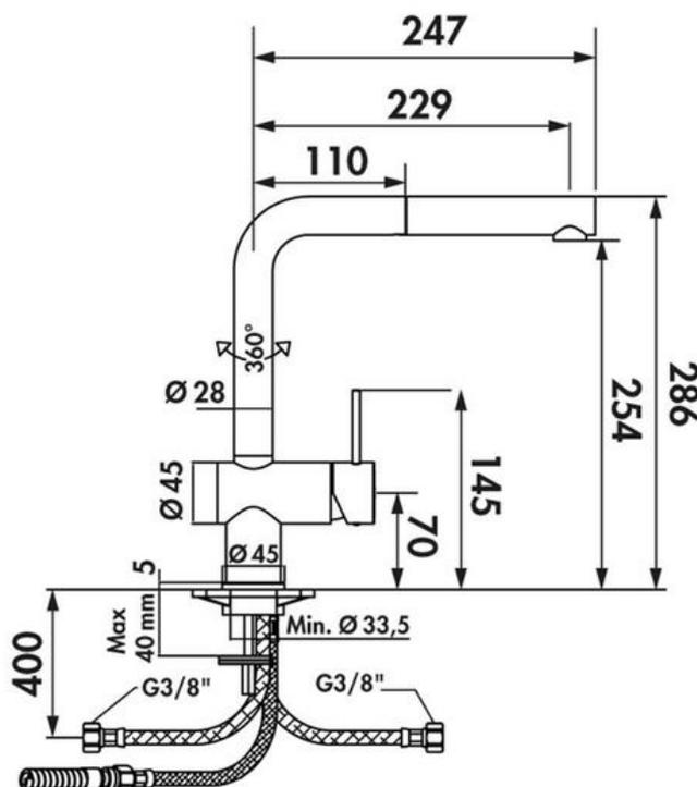
Diamètre de perçage : 35 mm
