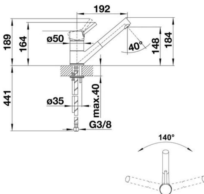
Diamètre de perçage : 35 mm
