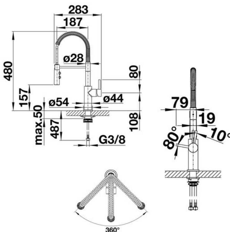
Diamètre de perçage : 35 mm
