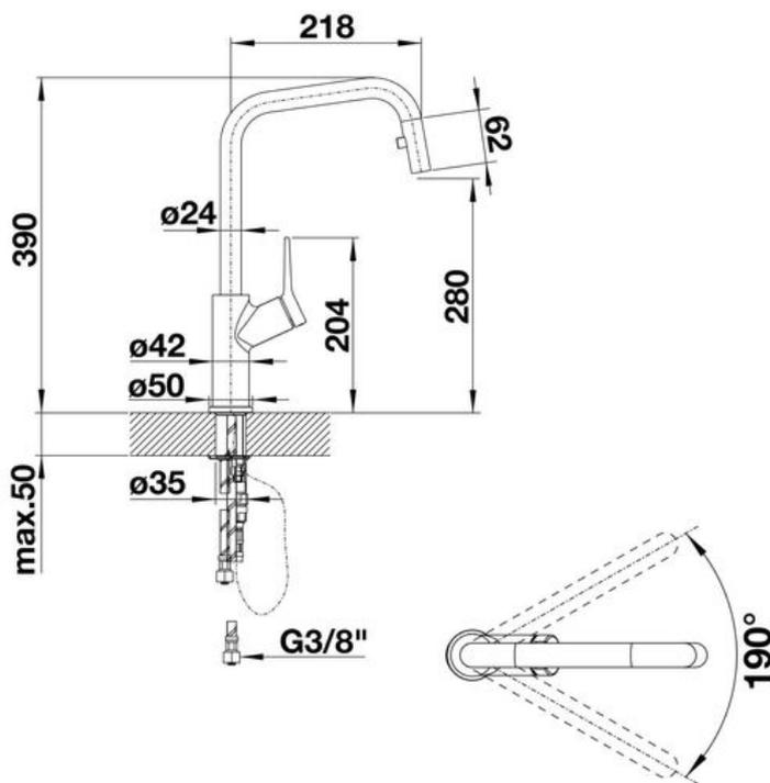
Diamètre de perçage : 35 mm
