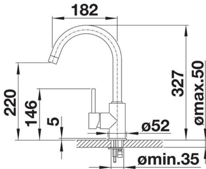
Diamètre de perçage : 35 mm
