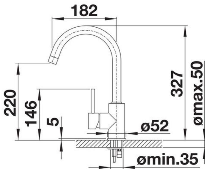
Diamètre de perçage : 35 mm
