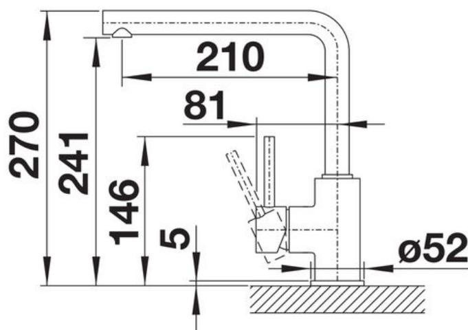
Diamètre de perçage : 35 mm
