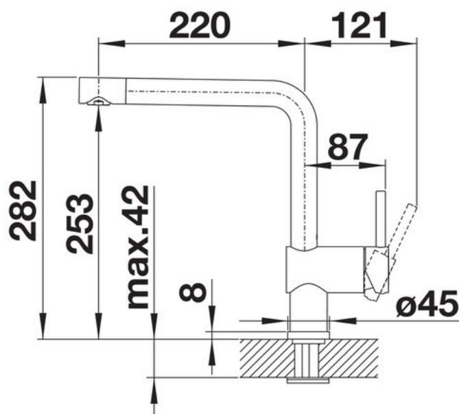
Diamètre de perçage : 35 mm
