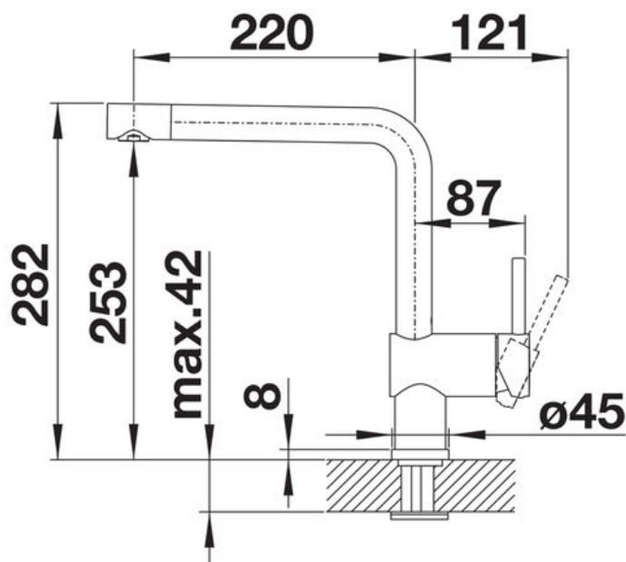
Diamètre de perçage : 35 mm
