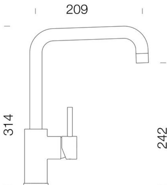
Diamètre de perçage : 35 mm
