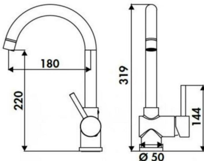
Diamètre de perçage : 35 mm
