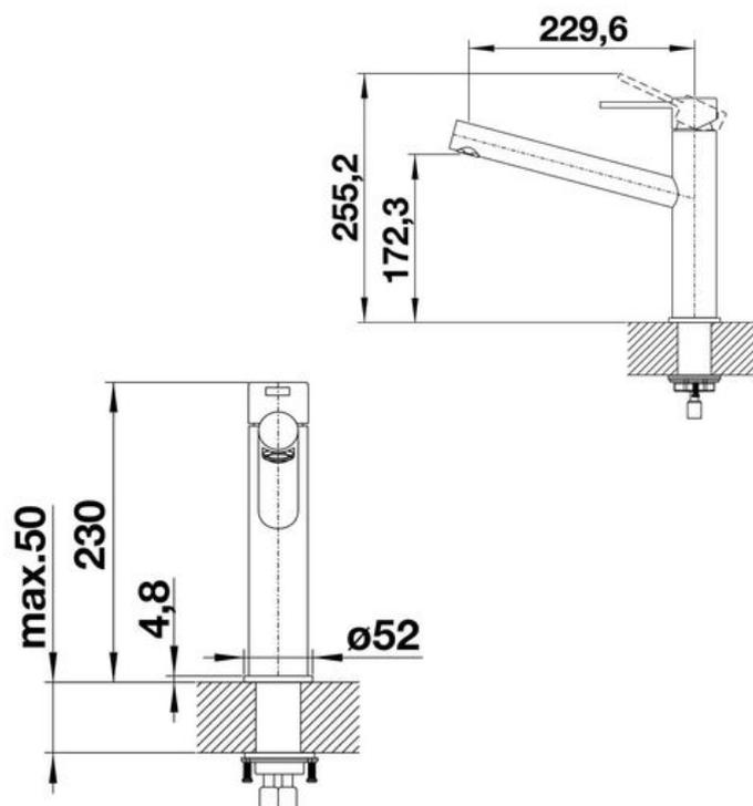
Diamètre de perçage : 35 mm
