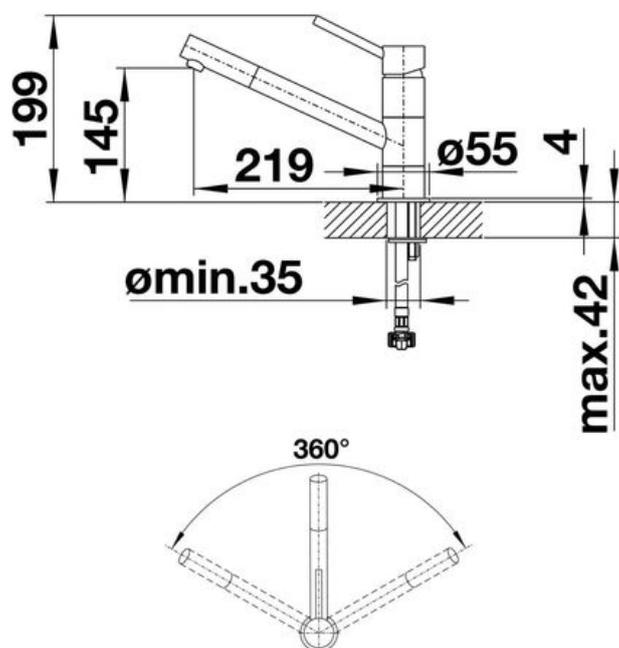
Diamètre de perçage : 35 mm
