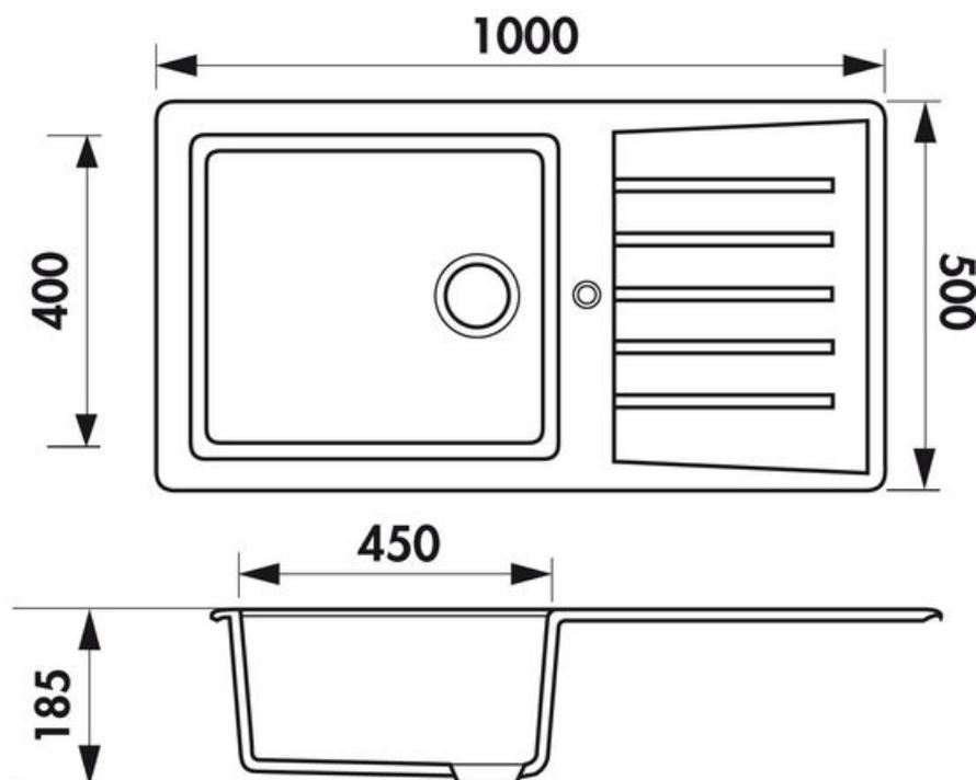
Profondeur de cuve : 185 mm
