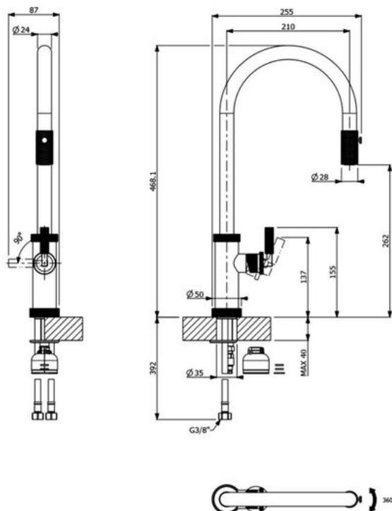
Diamètre de perçage : 35 mm
