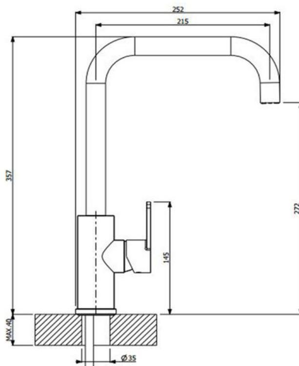
Diamètre de perçage : 35 mm
