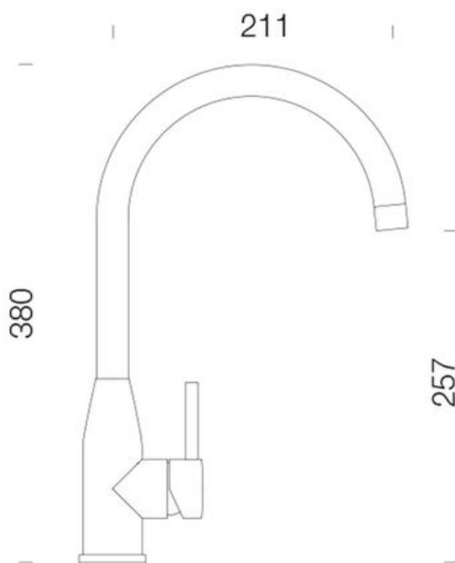
Diamètre de perçage : 35 mm
