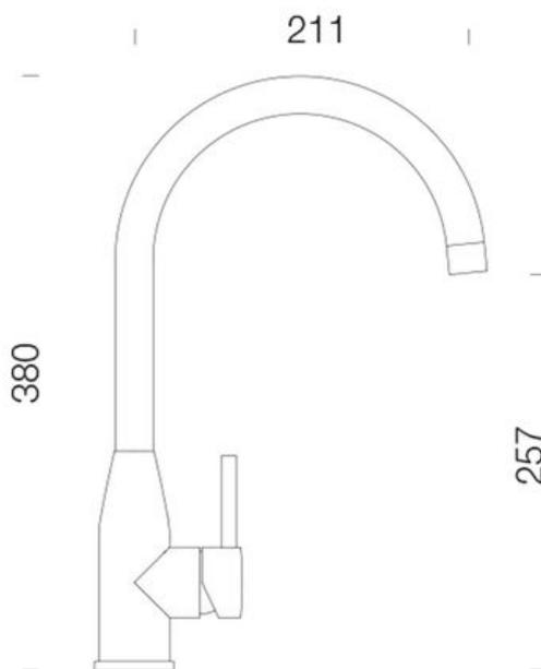
Diamètre de perçage : 35 mm
