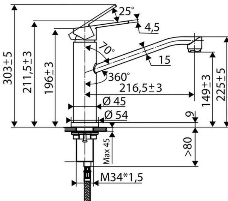
Diamètre de perçage : 35 mm
